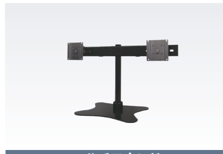
マルチスタンド 寸法 W750×H413.5×330mm 質量 約9.8kg 省スペースに複数のディスプレイを設置できるスタンドです。視覚位置や角度の微調整が可能です。 ※アーム1ヶ所当たりの耐荷重は4kgです。
