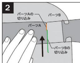
パーツAとBの切込みを合わせてパーツAを上へ押し上げてはめます。
