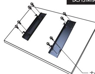
※使用する液晶ディスプレイ/テレビの穴径・深さにより、添付のネジが使えない場合がございます。ご使用の液晶ディスプレイ/テレビのメーカーホームページをご確認の上、適切な固定ネジをご用意頂き固定してください。
