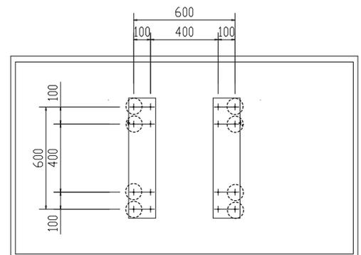
SHARP製 PN-R903 搭載時 (固定箇所：8点)
