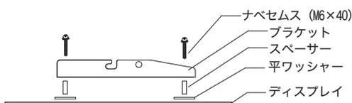
付属のネジ、ワッシャー、スペーサーを使い、ディスプレイとブラケットの間に隙間を作ります
