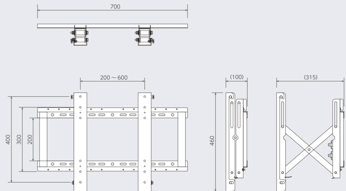
※埋込設置の場合は、図面上の想定より+15mmの深さで設置してください。
